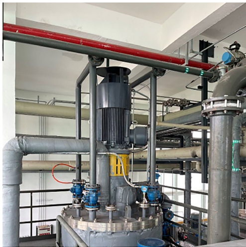
图 4 (网络版彩图)超重力强化分散橙288生产流程再造装置
