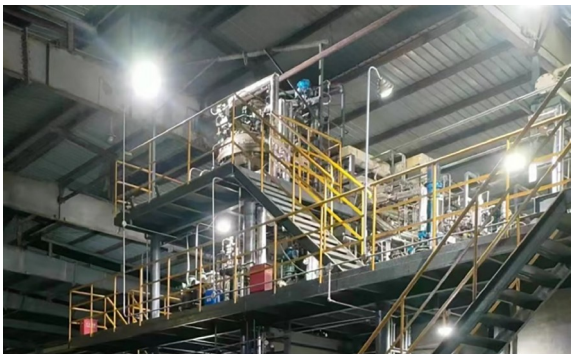
图 5 (网络版彩图)超重力强化分散蓝291中间体生产流程再造装置
