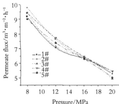
图2 成型压力与载体渗透通量之间的关系
