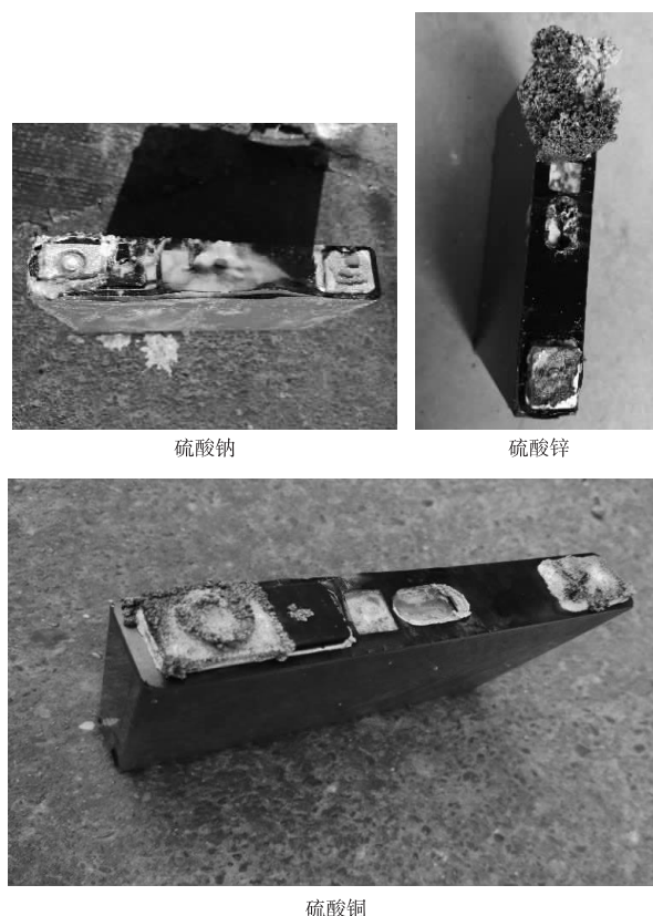
图 8 硫酸钠、硫酸铜、硫酸锌溶液放电电芯
