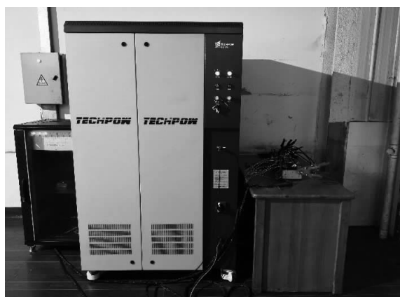
图1 德普BTS2000充放电测试系统
