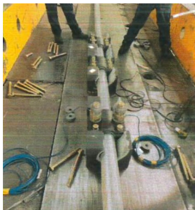
图4 索夹节点试验装置
