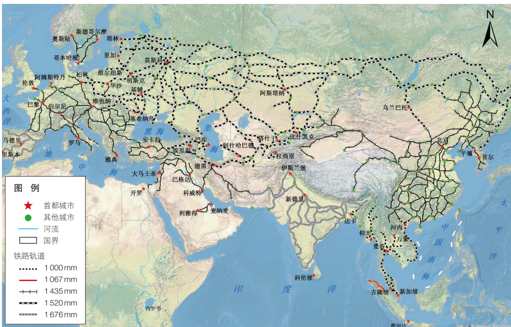
图1 “丝绸之路经济带”内铁路轨距分布示意图
