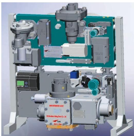
图 3 YZ-D 制动机结构示意图
