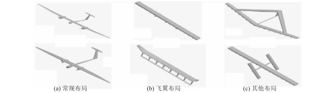
图 5 无人机几种典型气动布局形式
