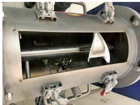
图 3 犁刀式混合机
