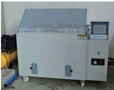
图 5 腐蚀试验现场
