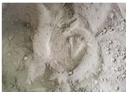
注:图中的块状部分是矿浆固结所致,并非试样的实际粒度。
