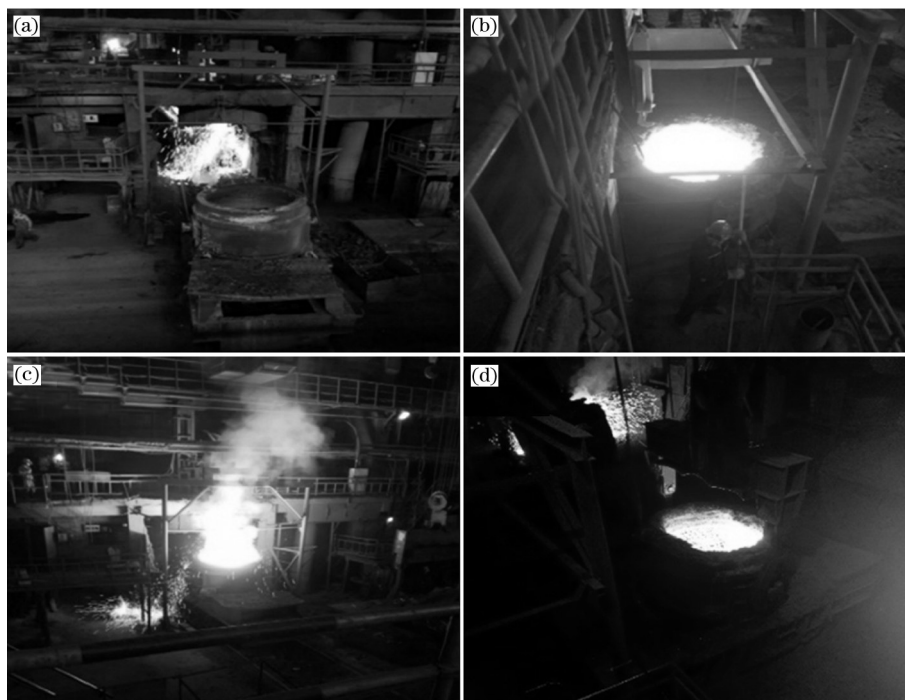
(a) 红包出钢; (b) 测温取样; (c) 钢包底喷粉; (d) 送至连铸区。
