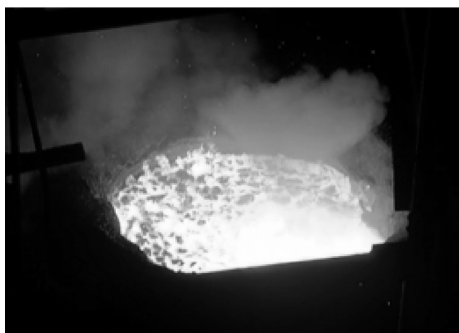
图 10 底喷粉过程中的钢液界面情况
