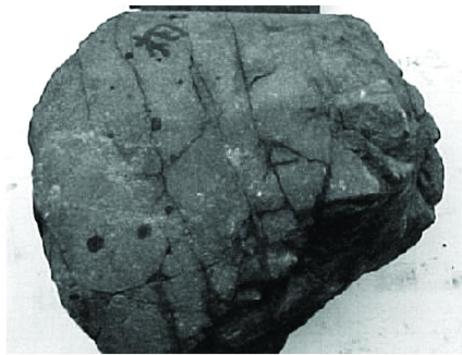
图1 川合 127 井须四低角度剖面“X”剪切缝
