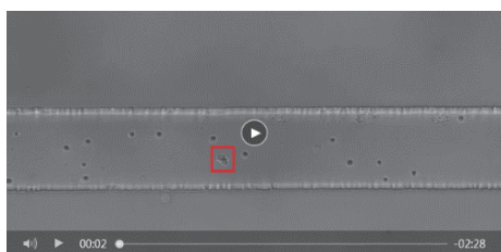
(a) 流量 12.7 \mu\text{L} 时, 小球藻颗粒在第 2 s 时的位置
