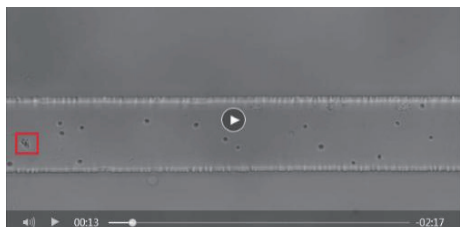
(b) 流量 12.7 \mu\text{L} 时, 小球藻颗粒在第 13 s 时的位置
