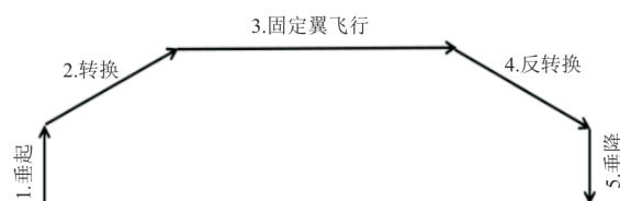
图1 复合翼eVTOL典型飞行剖面
