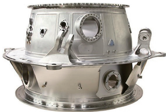
图 6 Trent XWB-84 发动机中间级压缩机匣
