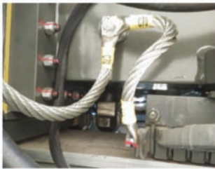
图 3 直线电机初级与车体端接图
