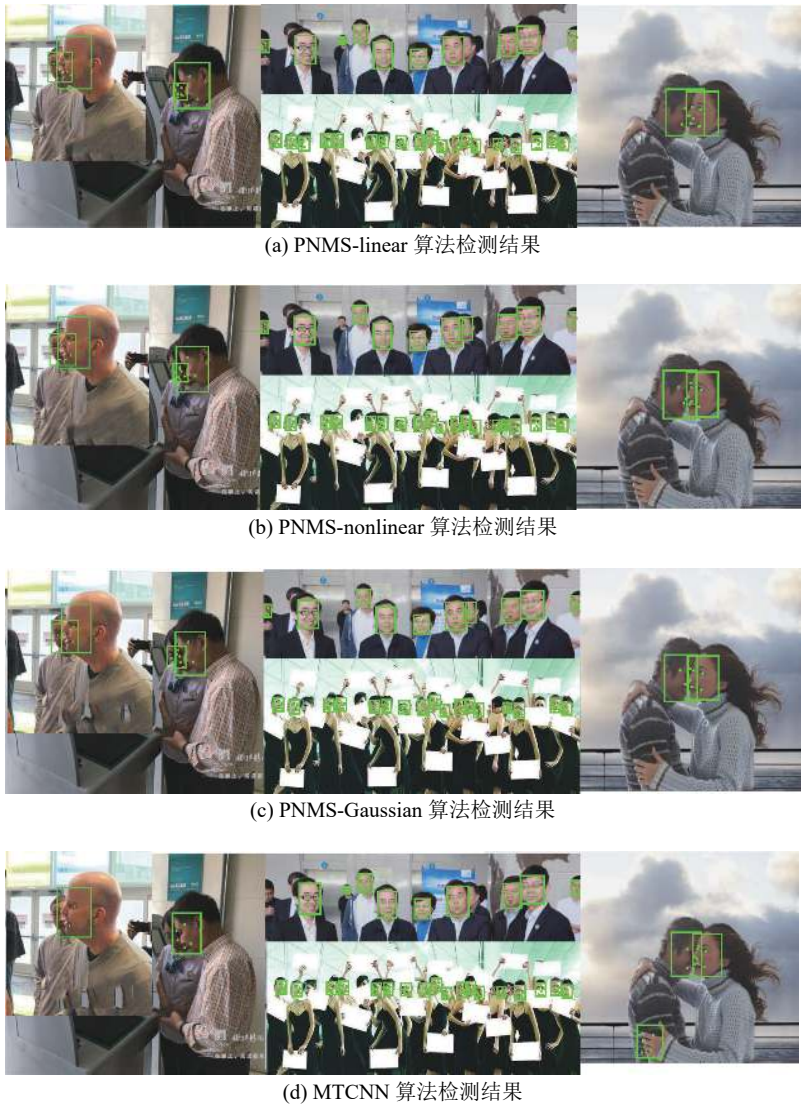
图 6 不同算法对部分遮挡人脸图像的检测结果对比
