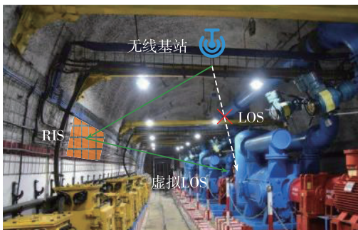
图 5 煤矿井下硐室内 RIS 部署示意
