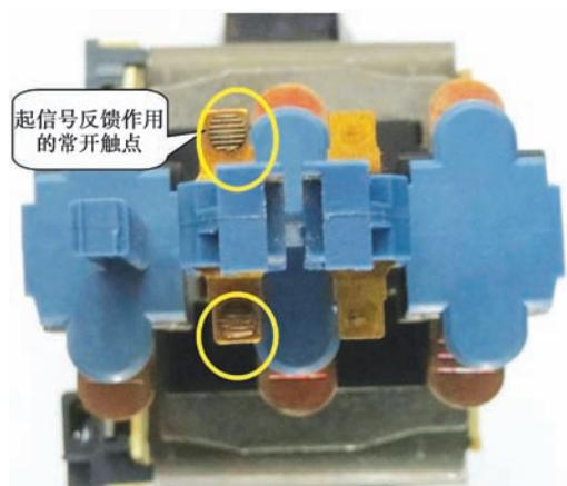
图4 接触器常开触头氧化
