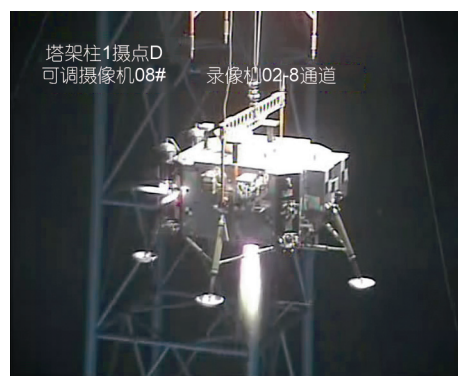
图 1 悬停避障缓速下降试验
