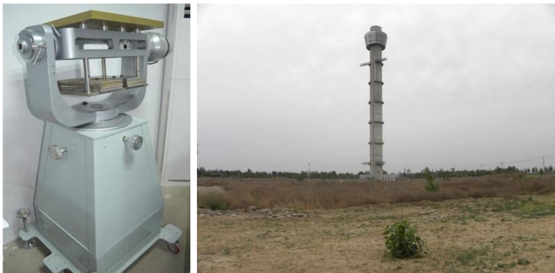
图 1 数据获取试验中使用的转台及高塔
