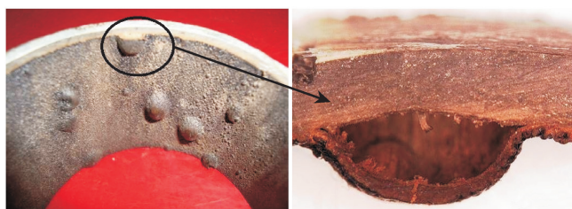
图 1 油气集输管线热塑性塑料起泡失效图
