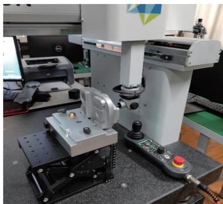
图4 被测零件装夹示意图
