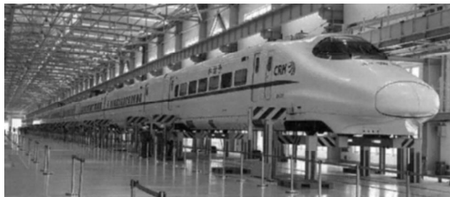
图3 整列弯臂地坑式架车机运用实景
