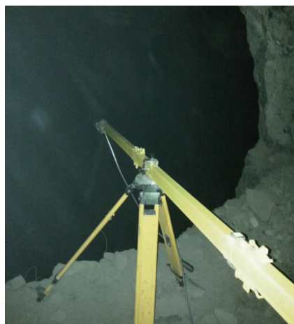
图 3 原矿用三维激光扫描测量系统中支撑系统工作示意图
