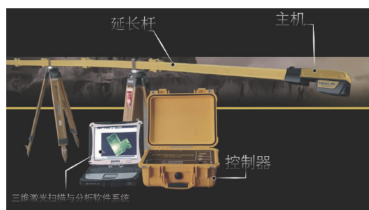
图 1 原矿用三维激光扫描测量系统
