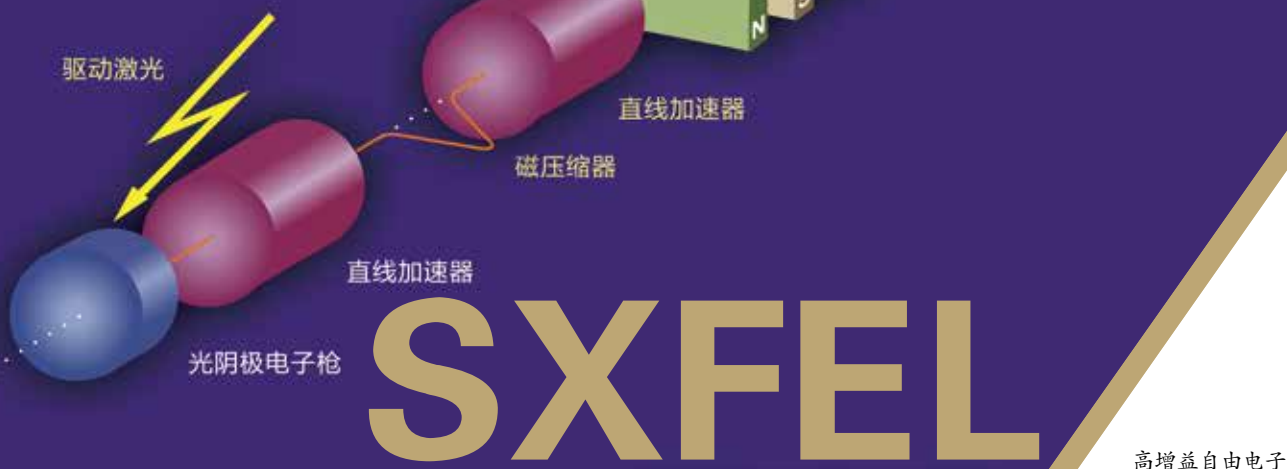
高增益自由电子激光工作原理
