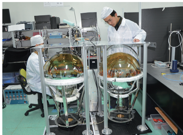
图2 江门中微子实验自主研发的20吋微通道板型光电倍增管
