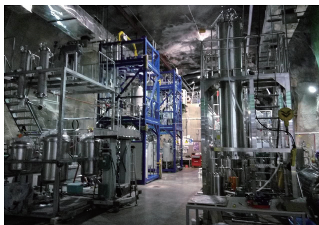
图3 在大亚湾搭建的中型液闪纯化系统
