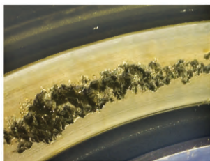
图1 外圈滚道表面损伤
