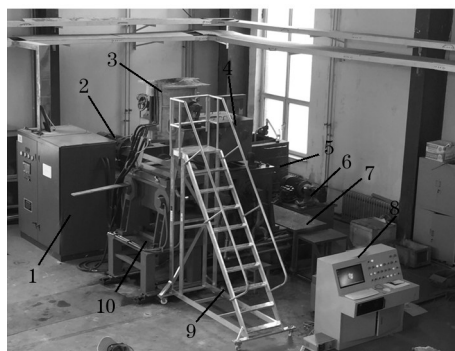
1—IGBT 电源; 2—电机及传动系统; 3—中频炉; 4—中间包; 5—冷却水箱; 6—液压泵站; 7—人工操作台; 8—电控操作 台; 9—梯具平台; 10—铸轧机主体。
