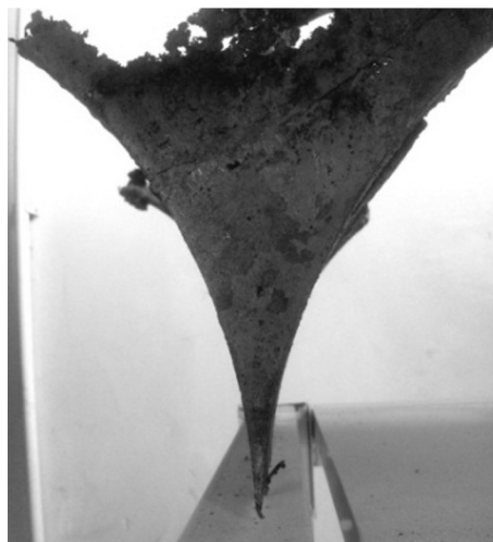
图 4 “轧卡”形成的熔池
