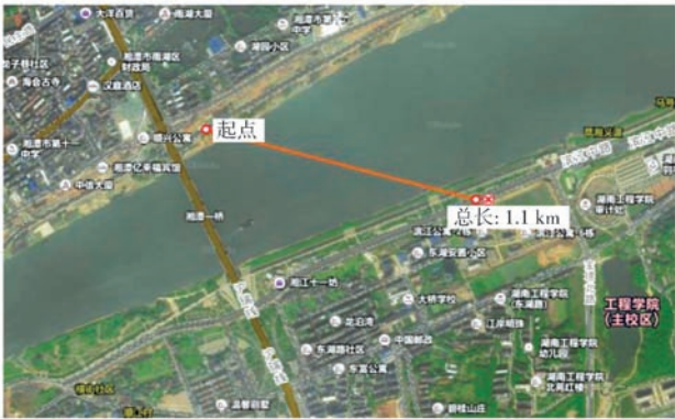
图 7 节点通信距离测试
