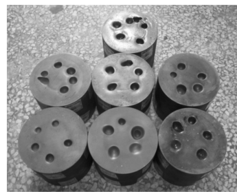
图2 磨料射流冲蚀后的金属试样
