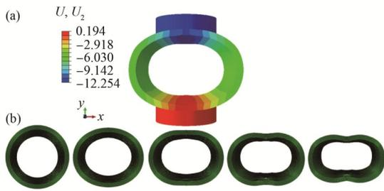
图4 导向管压缩过程中位移变化(a)和变形(b)
