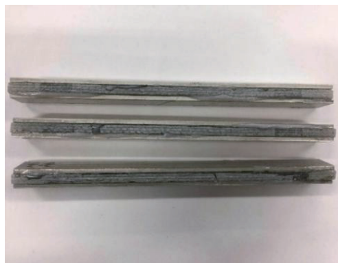
图7 粘贴增强片玻璃纤维层合梁试件
