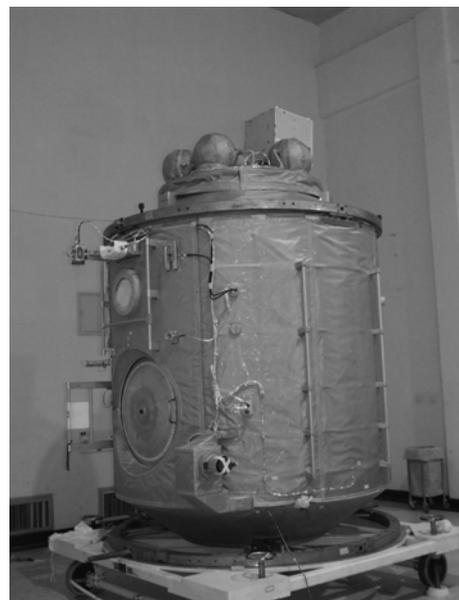
图 2 神舟七号飞船气闸舱整体结构
