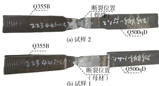
图 5 Q500qD 与 Q355B 异种钢对接焊接试样破坏位置
