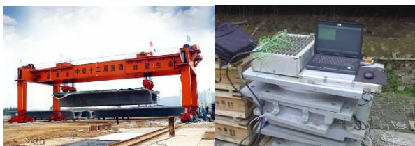
图 12 移梁机试验照片及应变接线图
