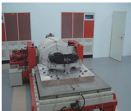
图 12 反射镜组件振动试验装置
