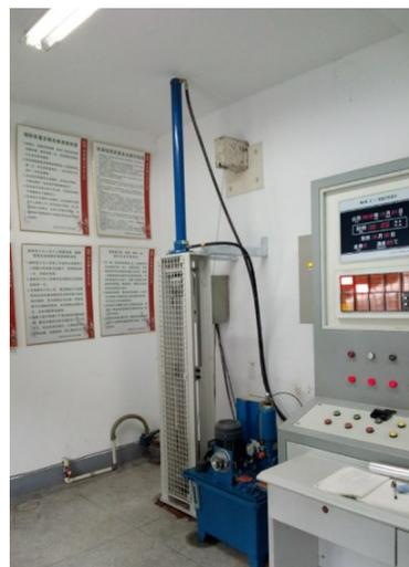
图3 钴源辐照装置的液压提升装置和操作控制台
