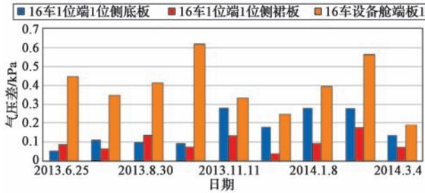
图 11 设备舱压差不同季节对比图
