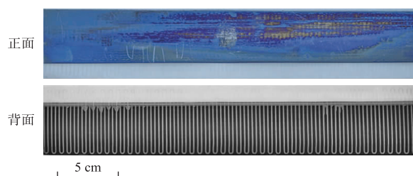
图2 报废不锈钢衬底CIGS芯片样品
