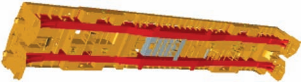
图 7 双中梁承载式轻量化车架
