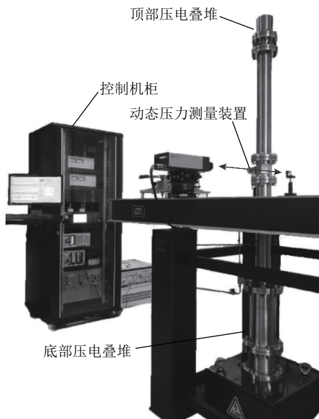
图2 高频液体正弦压力校准装置
