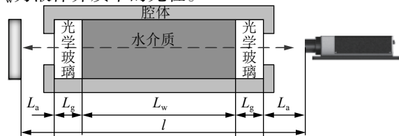
图3 测量光路示意图
