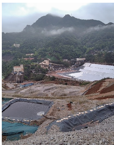
图 1 生物提铜萃取尾液循环喷淋浸铜尾渣试验堆
