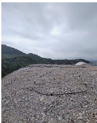
图 1 生物提铜萃取尾液循环喷淋浸铜尾渣试验堆
