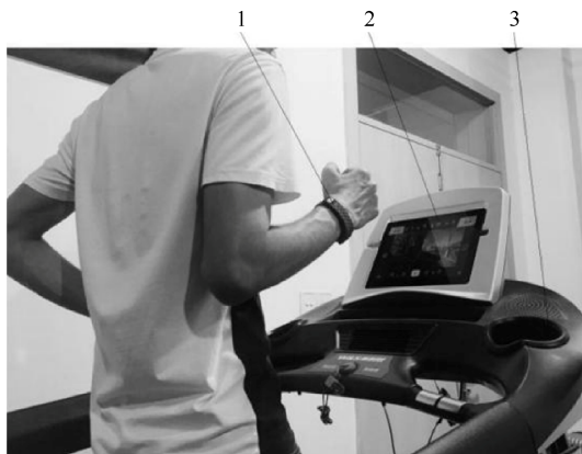
图7 实验平台(1.心率测量设备;2.控制系统平台;3.跑台)
