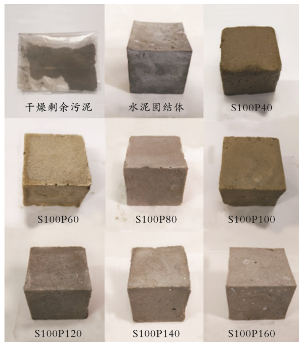
图4 干燥剩余污泥、水泥固结体与剩余污泥-水泥固结体的照片
