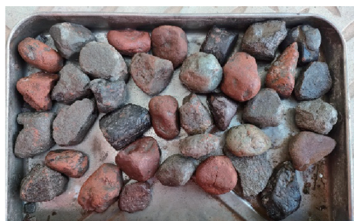
图 2 SDCK1 井分段重稠浆举屑携带出的井下掉块
