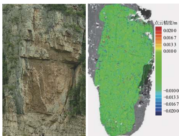
图 10 点云精度分析结果
