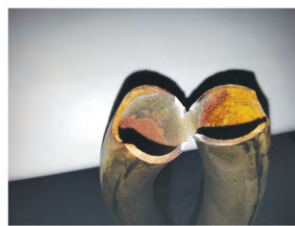
图6 断口宏观形貌
