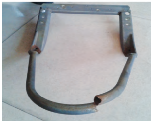
图2 弓角弯管断裂
