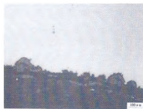
图9 管外表面显微组织
