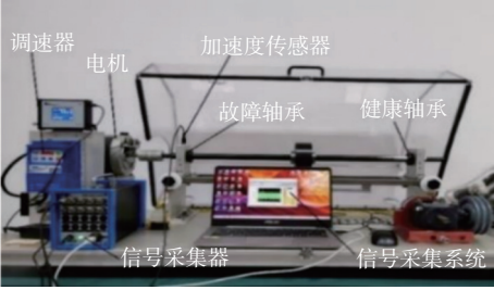
图 6 MFS 机械故障仿真试验台
