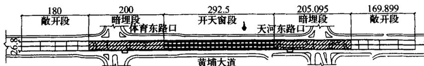
图 1 隧道平面布置图 (单位: m)
